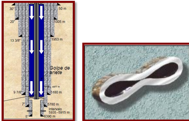
Figura 17 “Desgaste por depresionamiento inadecuado”
