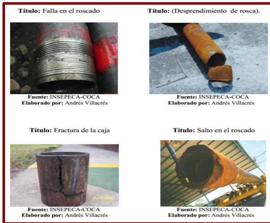
Figura 28 “Fallas por tensión”
